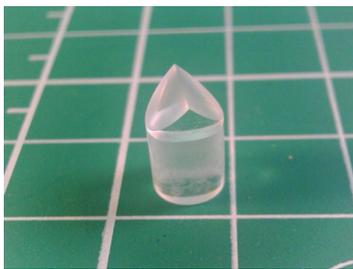
(a) 先端が斜め45度の2面を持つアクリル製キャップ (外径6mm, 高さ10mm)
